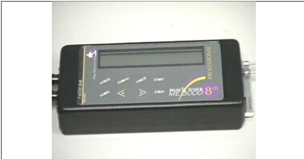
Figura. 8 Detall del electromiógrafo de superficie de ocho canales: Mega 3000P8 (Mega ElectronicsLtd, Kuopio, Finlandia)
