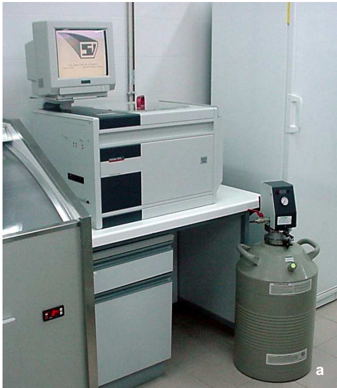
Fig. 9. a: Biocongelador (Icecube 1810, Minitüb), b: Racks de pajuelas para almacenaje de espermatozoides criopreservados, c: Etiquetadora de pajuelas de semen criopreservado..
