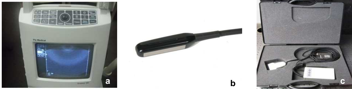
Fig. 1. a: Ecógrafo Pie Medical SC100 utilizado para llevar a cabo las ecografías transrectales en las cerdas. b: Sonda sectorial de 5 MHz. c: Sonda lineal de 7.5 MHz.
