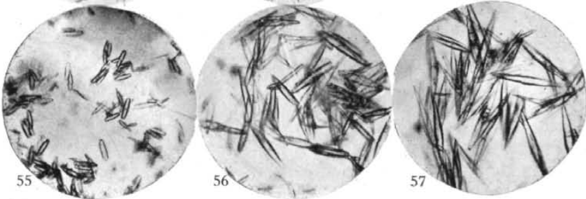
Figs. 53-57. — Precipitando con mercurisulfocianuro sódico, en presencia de cantidades distintas de acetato sódico y lactato sódico.
