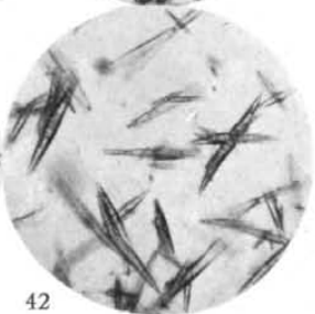
Figs. 38-42.—Precipitando con mercurisulfocianuro sódico, en presencia de distintas concentraciones de acetato sódico.
