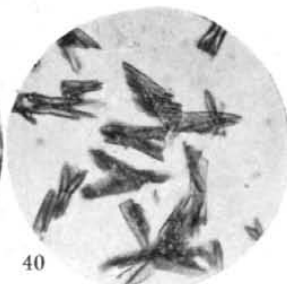
Figs. 38-42.—Precipitando con mercurisulfocianuro sódico, en presencia de distintas concentraciones de acetato sódico.
