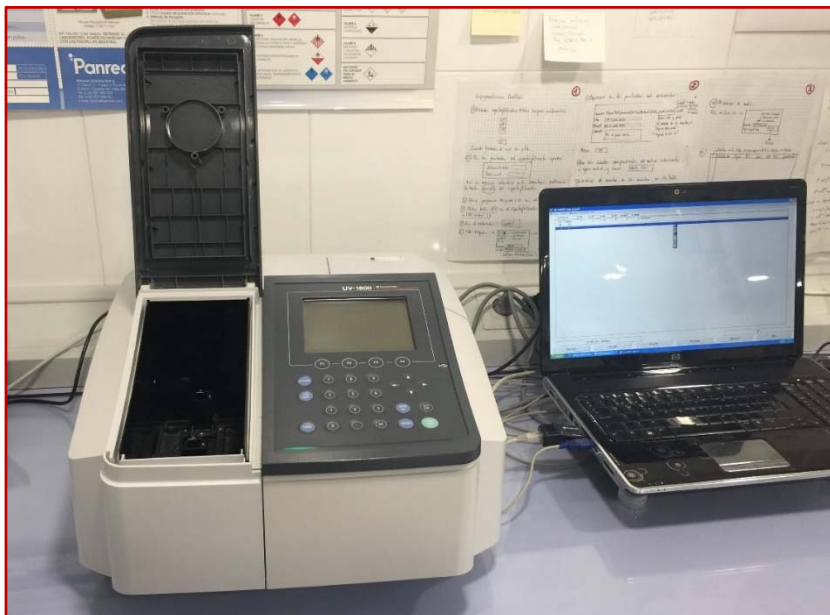
Figura 32. Espectrofotómetro en el que se realizaron las medidas de los parámetros cromáticos
