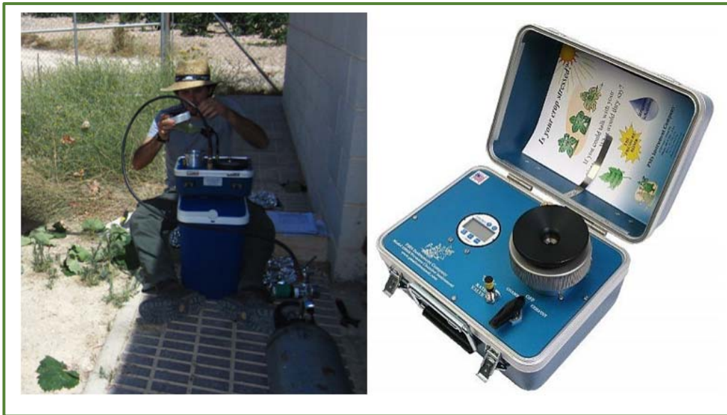
Figura 26. Cámara de presión utilizada para realizar las medidas de potencial hídrico de tallo a medio día solar.
