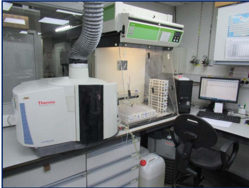
Figura 30. Plasma de acoplamiento inductivo acoplado a un espectrofotómetro de emisión óptica (ICP-OES).
