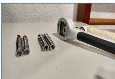
Figura 15. Dinamómetro digital y muelles intercambiables.
