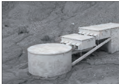
Figura 1. Batería de tanques instalados en una Parcela para el Estudio de la Erosión sobre las arcillas de la Fm. Tudela.
