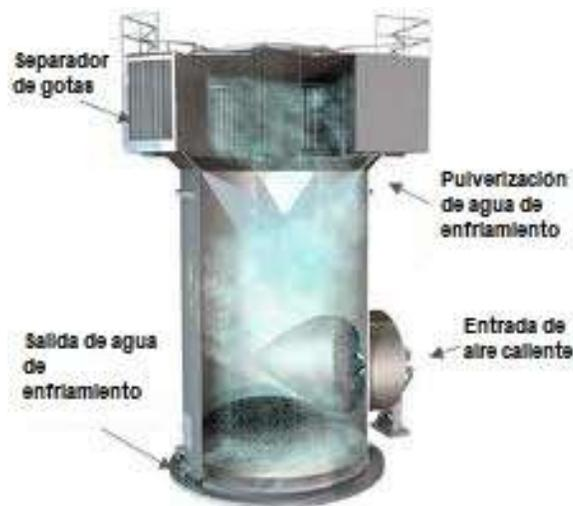
**Figura 3.8.** Esquema del interior de un *quench* [70]
