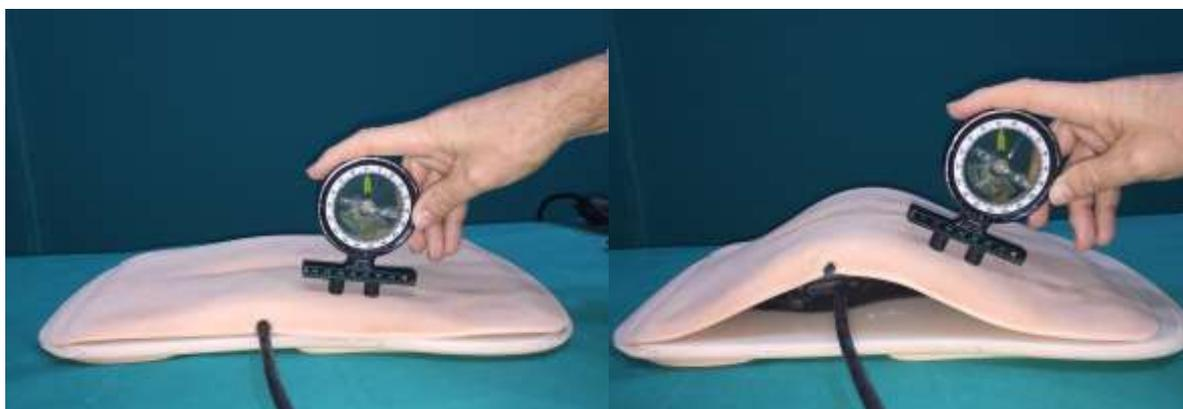
*Figura 24. A la izquierda, cuantificación del mínimo grado de curvatura lumbar que es de 20° como en el LumboSant clásico. A la derecha, máxima curvatura lumbar que puede obtenerse con el LumboSant-2, que es de 60°.*
