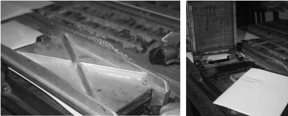
Fig. 2 – Fecho da tampa da imprensa e mostra das palavras impressas
