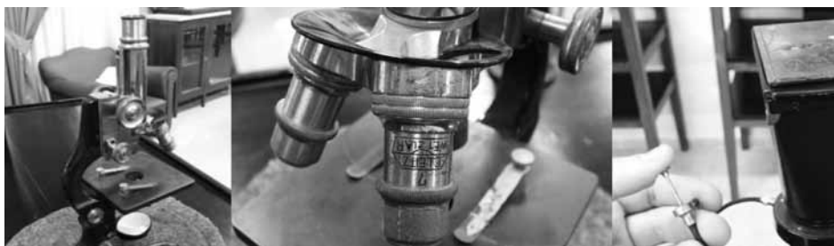
Microscopio de la casa Ernst Leitz de Wetzlar, con su número de serie y detalle de los objetivos. Cámara de fotos incorporada al microscopio con disparador manual.
