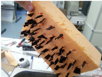
Figura 4.1 - Termopares separados 1cm entre sí y de la pared de la cubeta
