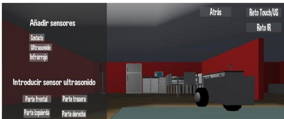
Fig. 32. Añadiendo un sensor de ultrasonidos a la parte frontal del robot
