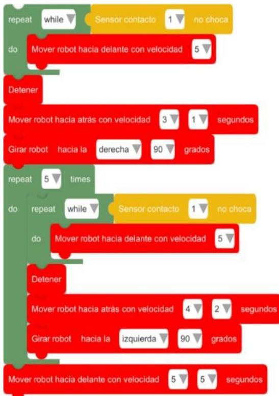
Fig. 29. Programa asociado al robot con sensor de contacto
