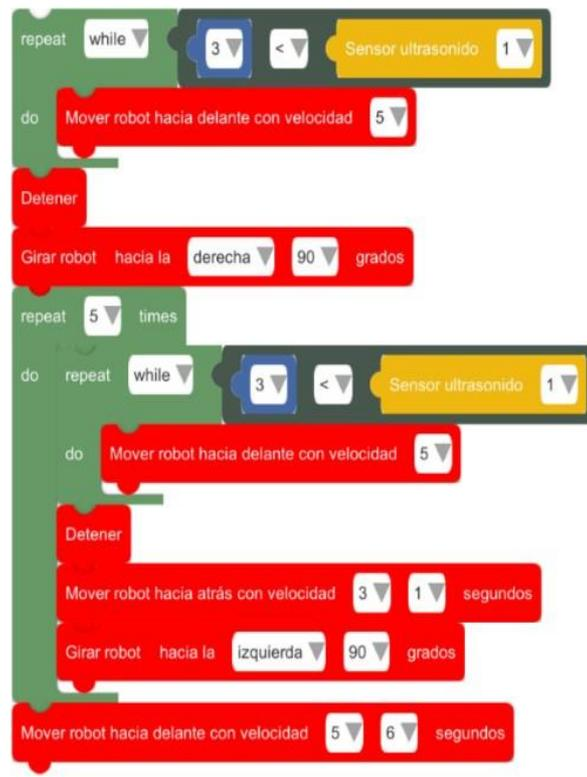
Fig. 30. Programa asociado al robot con sensor de ultrasonidos
