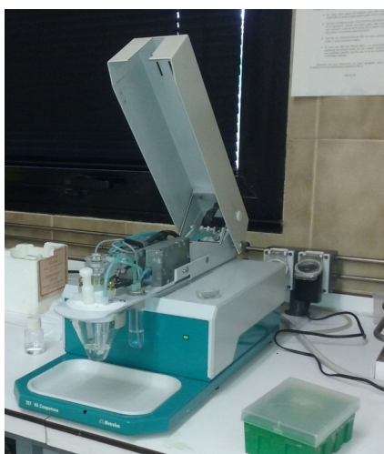
Foto 6. Polarógrafo Metrohm®. Puesto de trabajo VA-757. Autor foto: Antonio J. García.
