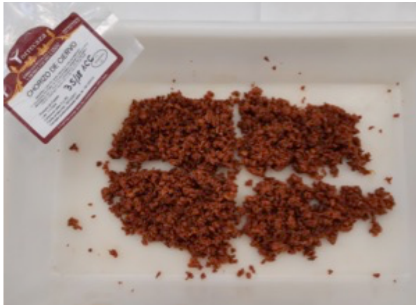
Foto 3. La muestra analítica debe ser representativa. Se llevaron a cabo procedimientos para alicuotar muestras haciendo submuestreros del material previamente homogenizado. Autor foto: Antonio J. García.
