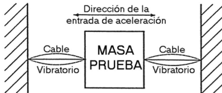
Figura 4.11: Acelerómetro de cables vibratorios de ejes sencillos.
