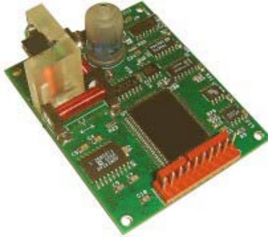
Figura 6.32: El compás electrónico TCM2-50 de *Precision Navigation*.
