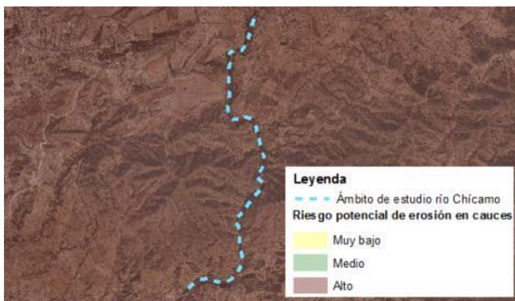
Figura 7.12. Riesgo potencial de erosión en el cauce del río Chícamo.
