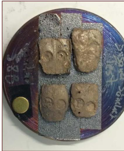
**Fig.27-** Muestras deshidratadas, cubiertas con carbón y etiquetadas para la observación y microanálisis de elementos.
