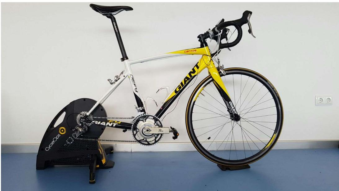
Figura 7. Bicicleta con bielas SRM instalada en el rodillo Cycleops Hammer
