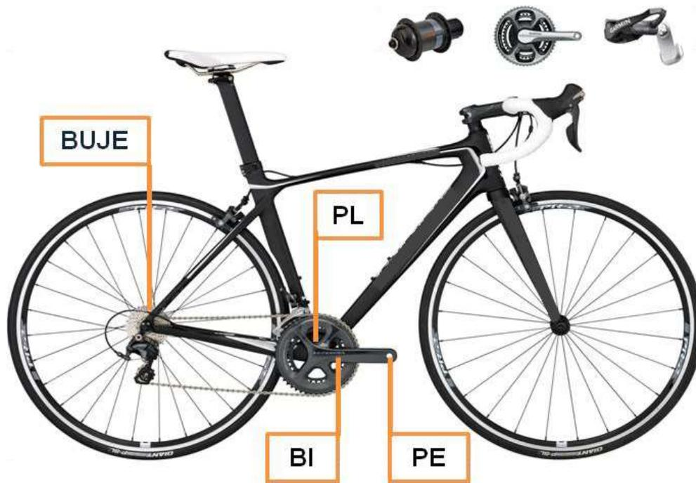
Figura 1. Localización de los instrumentos de medición de potencia integrados en la propia bicicleta. Plato, buje trasero, bielas y pedales (Cavas, 2015)
