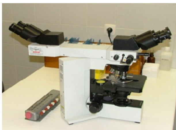
Figura M11. Microscopio OLYMPUS BX40 (vistas lateral y frontal)
