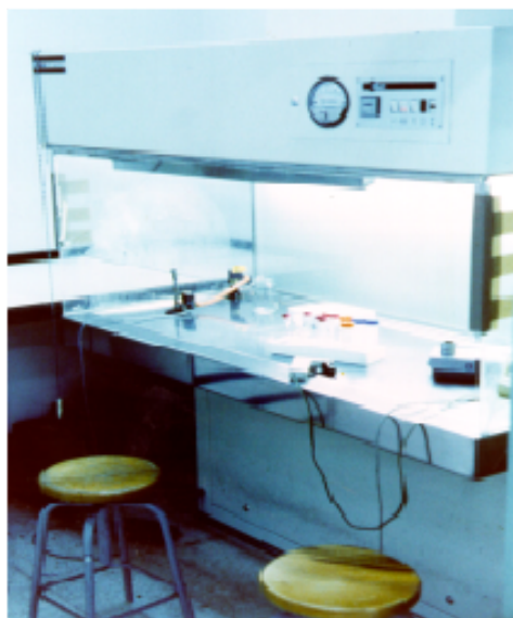
Figura M6. Cabina de flujo laminar usada para la manipulación y cultivos de linfocitos de sangre.
