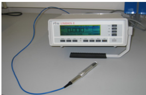
Figura M8. Electrómetro con sonda utilizado en este estudio.
