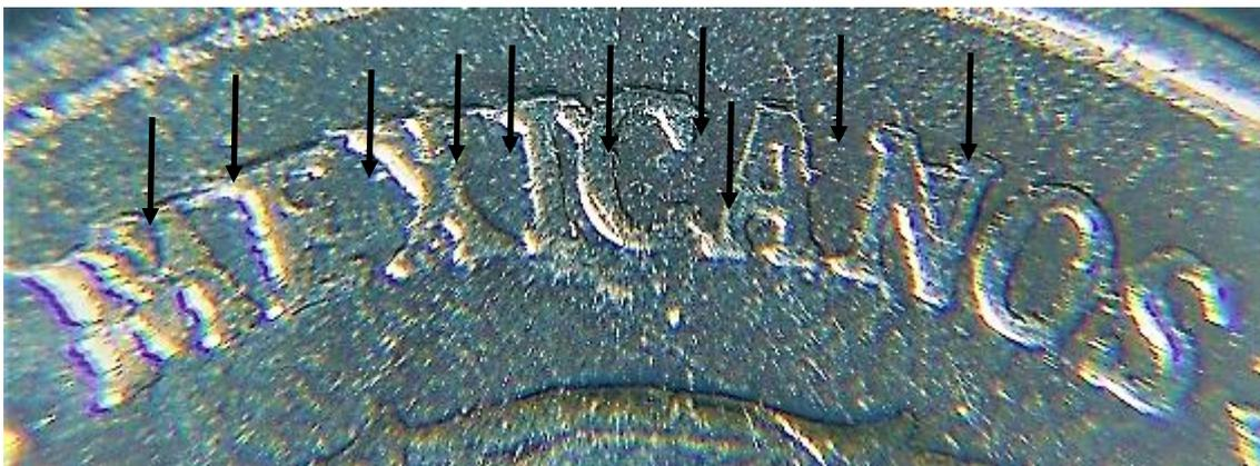
Figura 8. Ruptura de troquel en el anverso en las letras M, E, X, I, C, A y N de la palabra MEXICANOS.
