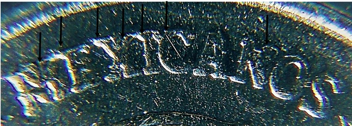
Figura 7. Ruptura de troquel en el anverso en las letras M, E, X, I, C y N de la palabra MEXICANOS.
