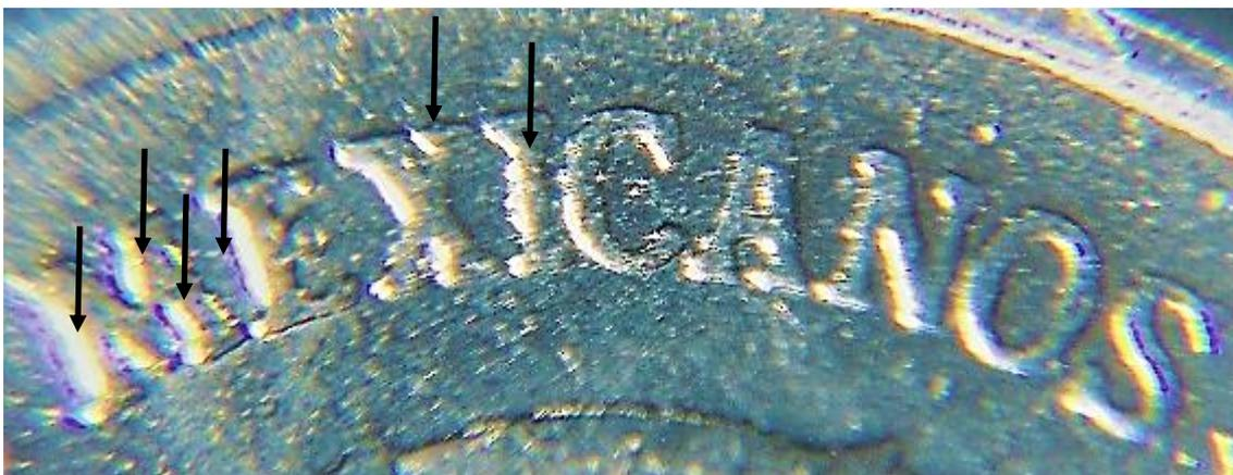
Figura 11. Figura 10. Ruptura de troquel en el anverso en las letras M, X, e I de la palabra MEXICANOS.
