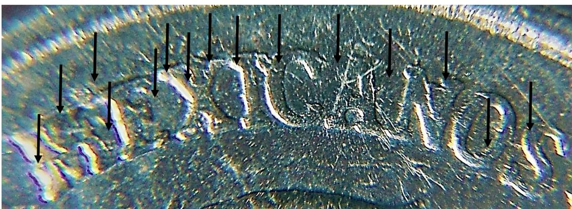
Figura 10. Ruptura de troquel en el anverso en las letras M, E, X, I, C, A, N, O y S de la palabra MEXICANOS.
