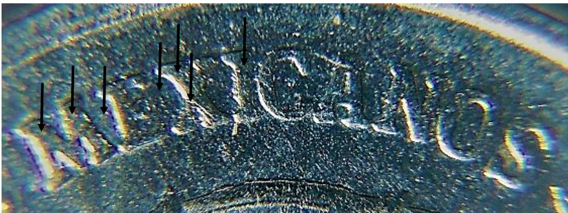
Figura 12. Figura 10. Ruptura de troquel en el anverso en las letras M, E, X, e I de la palabra MEXICANOS.
