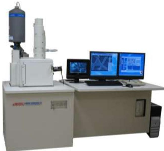
**Figura 2.** Fotografía del microscopio electrónico de barrido (SEM) - JEOL JSM 5900LV
