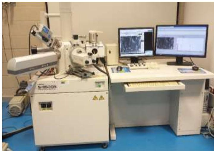
**Figura 2.** Fotografía del microscopio electrónico de barrido (SEM), HITACHI S-3500N
