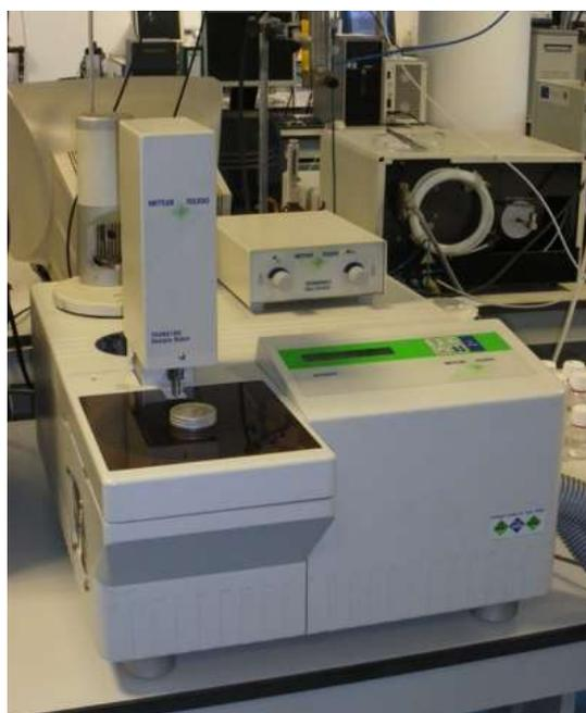
**Figura 1.** Fotografía del Calorímetro de Barrido Diferencial -DSC 822e Mettler-Toledo
