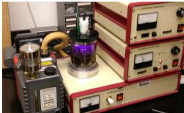
**Figura 3.** Fotografía del Módulo SPI para recubrimiento por pulverización catódica
