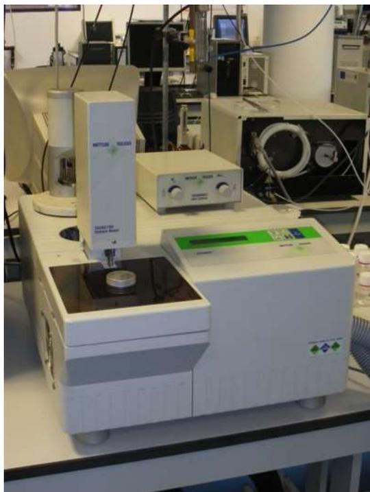
**Figura 1.** Fotografía del Calorímetro de Barrido Diferencial -DSC 822e Mettler-Toledo
