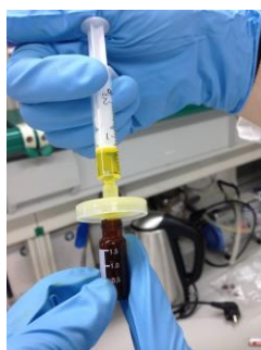
Figura 23. Preparación de las muestras de 20 \mu L del extracto acuoso para su inyección en el equipo de HPLC-DAD
