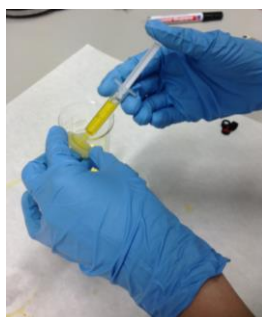
Figura 22. Filtrado de la solución a través de un filtro PTFE, con un tamaño de poro de 0,45 \mu\text{m}
