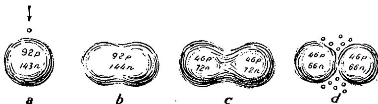
FIG. 65. Escisión del uranio.—En este esquema hemos representado el caso, hipotético, de la escisión del núcleo de uranio en dos fragmentos de igual masa.
