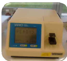
Figura 15.. Osmómetro Vapro® 5520 (Wescor)
