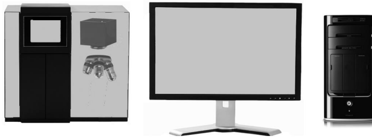
Figura 5. Sistema de patología digital. Escáner (izquierda), monitor (centro), ordenador (derecha).
