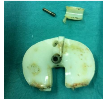
Fig. 36. Rotura de polietileno (fallo tipo 3 de Henderson) en grupo tibial
