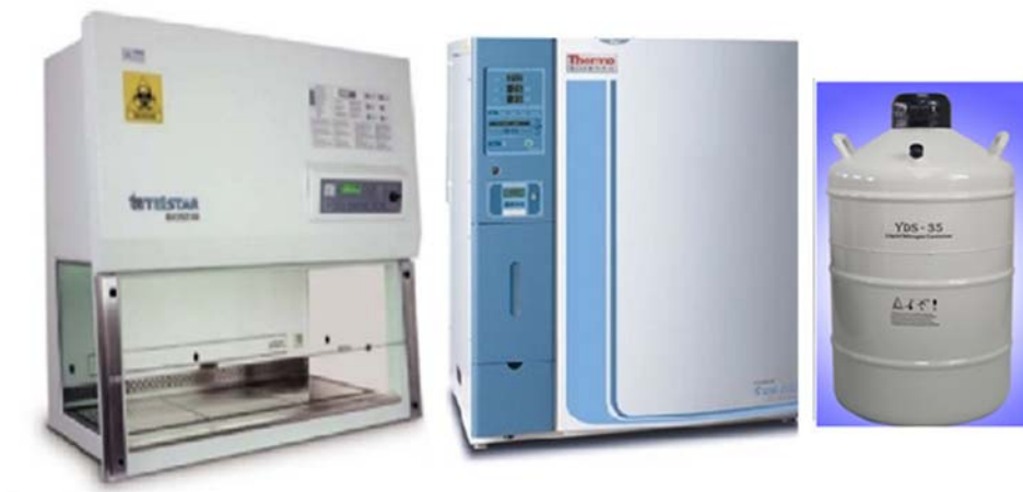
Figura 3. 1. Cabina flujo laminar, incubador de CO 2 y depósito de nitrógeno líquido. Cabina Cytostar de flujo laminar vertical de seguridad biológica y química de clase II de Telstar (panel izquierdo). Incubadores de CO 2 Steri-Cult 3310 de Thermo Scientific (panel central). Depósito de nitrógeno líquido MVE Cryo System 4000 de Cryo Solutions LS3000 (panel derecho).
