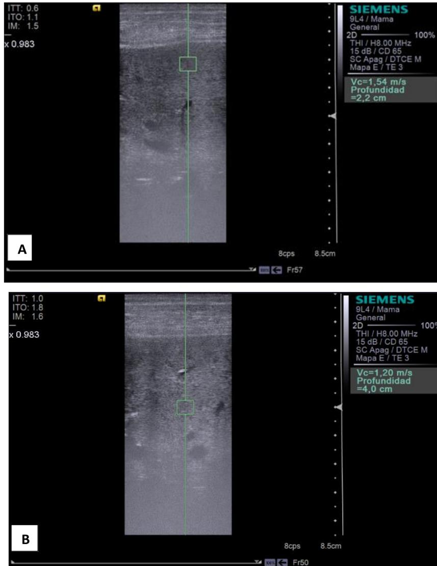
**Figura 3.3.** Efecto de la profundidad. En la figura A se ha seleccionado una RDI a 2.2cm, con unos valores de velocidad de corte de 1,54m/s. En la figura B hemos establecido una RDI a mayor profundidad que en A (4cm), con la obtención de una velocidad de corte inferior (1,2m/s). Fuente: elaboración propia
