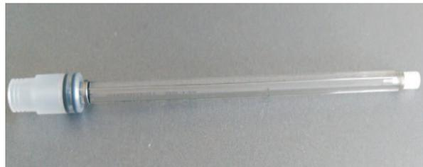
Figura 3.5: Capilar que se introduce en el módulo Lovis 2000 ME.
