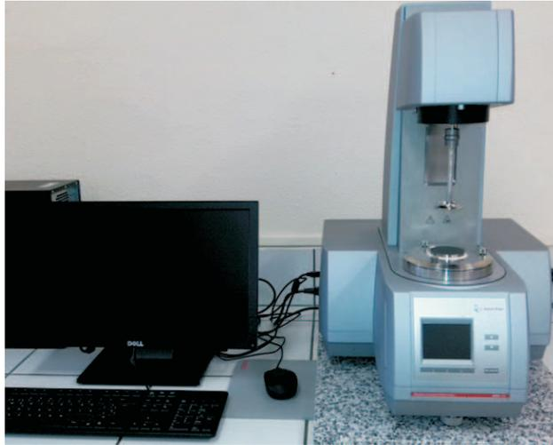
Figura 4.5: Reómetro Anton Paar MCR 102 utilizado en esta Tesis.
