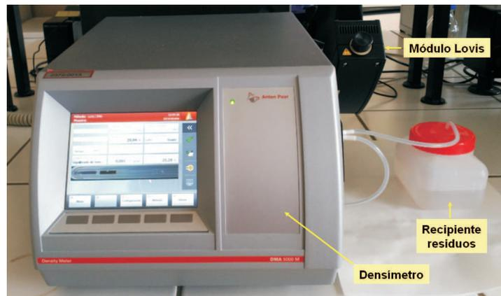
Figura 3.4: Densímetro DMA 5000 M de Anton Paar con módulo Lovis 2000 ME.
