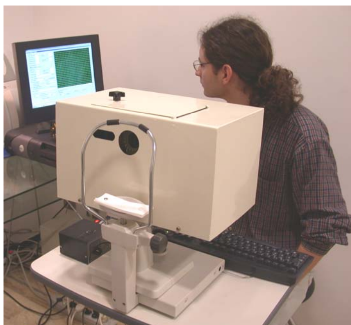
Figura 2,03. Imagen del HS clínico. Como puede observarse, la plataforma va montada sobre soporte móvil que además lleva una mentonera, y una mesa elevable. Se utiliza un PC para registrar las imágenes y procesar la aberración de frente de onda.
