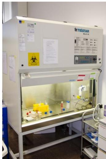
**Figura 6.** Cabina de seguridad biológica vertical tipo II.
