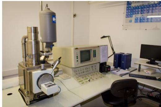
Figura 14. Microscopio electrónico de barrido Jeol 6100.
