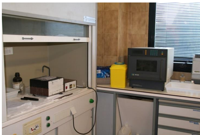
Foto IV.11. Puesto de digestión. Cabina extractora de humos y bloque digestor.
