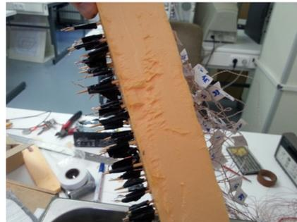
Figura 5.2 - Termopares etiquetados por separado
