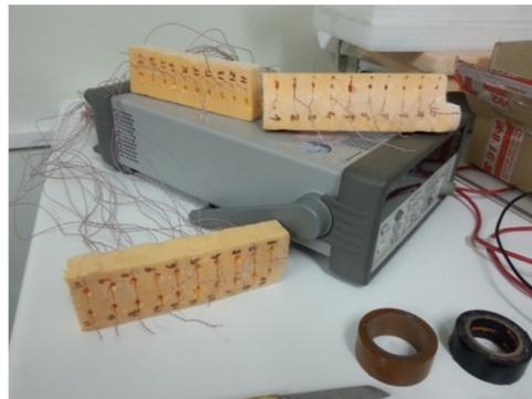
Figura 2 - Termopares tipo T fabricados en laboratorio
