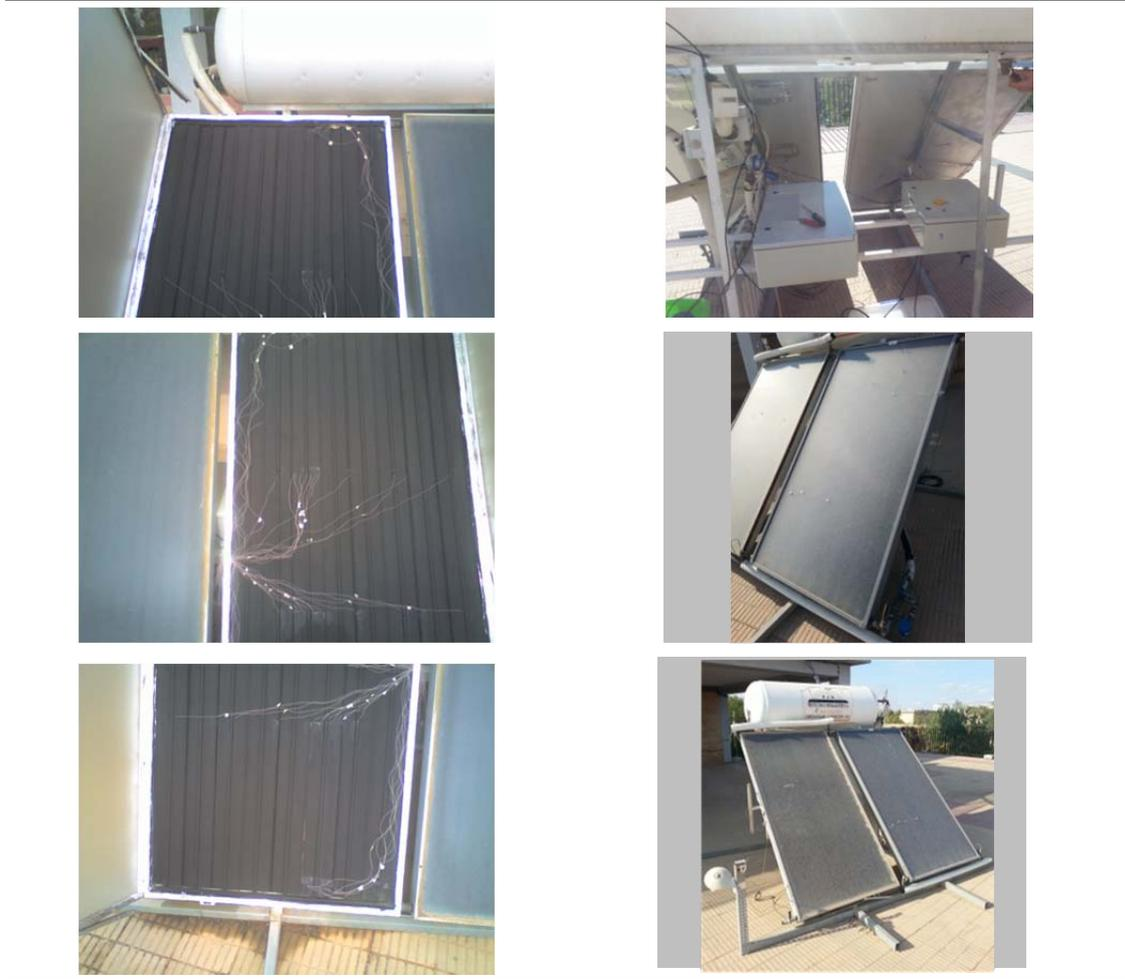
Fig. 41 – Instalación de termopares en Captador 2 (izda.). Unidades adquisición datos e higrómetro (dcha.arriba). Termopares cristal y cámara aire (dcha.centro). Conjunto (dcha.abajo)
