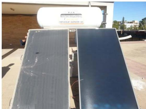
Fig. 32 – Vista frontal de captadores solares térmicos planos instrumentados objeto de estudio. GALEM VS2.0 (derecha), GAROL-I (izquierda)
