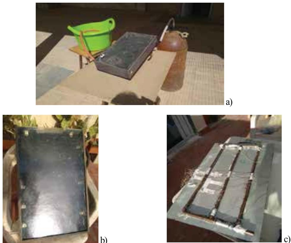
**Fig. 2.** Montaje para experimentación de captador de energía solar térmica para generación de agua caliente. a) Sistema conjunto; b) Captador; c) Placa absorbidora y parrilla de tubos (visión trasera).
