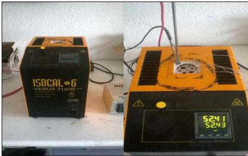
Figura 7: Calibración de termopares
