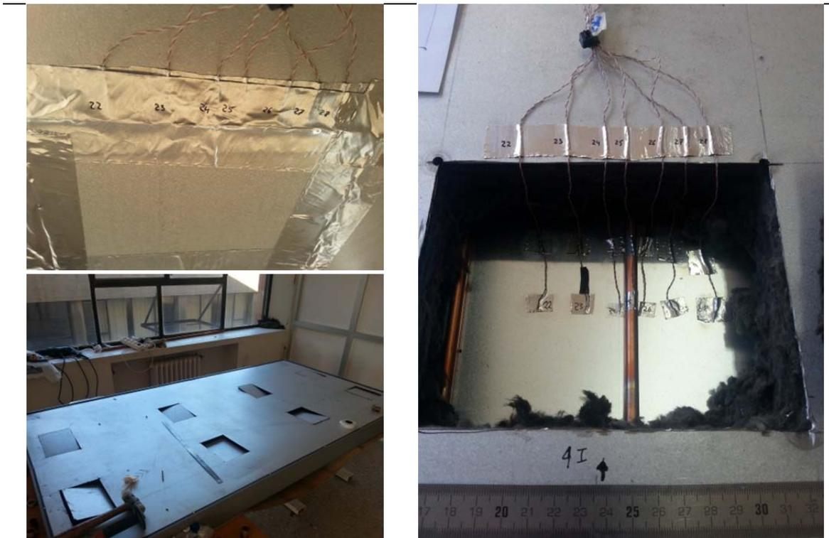
Fig. 40 – Instalación de termopares en Captador 1. Aberturas carcasa trasera (izda. abajo). Termopares bajo absorbedor (dcha.). Sellado final de aberturas (izda. Arriba)
