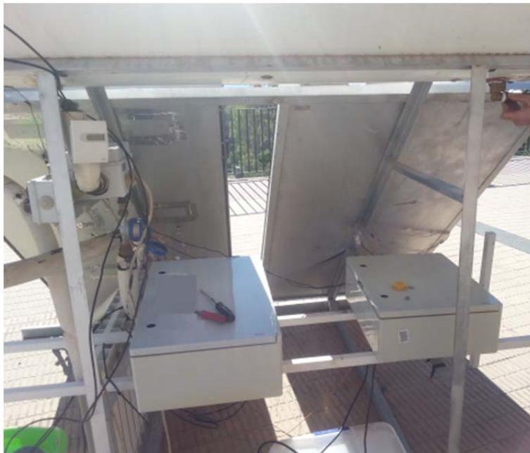
Fig. 43 – Unidades de adquisición de datos en cajas estancas
