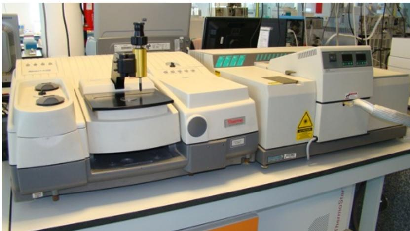
Figura 13. Espectrofotómetro Thermo Nicolet 5700.
