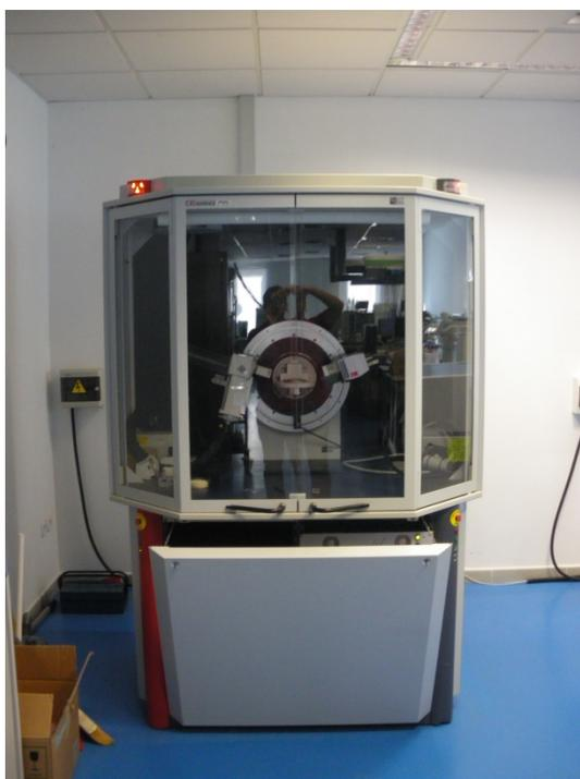
Figura 11. Difractómetro de rayos X D8 Advance en modo  $\theta$ - $\theta$ , Bruker.
