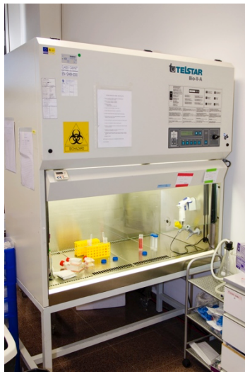
Figura 9. Cabina de seguridad biológica vertical tipo II.
