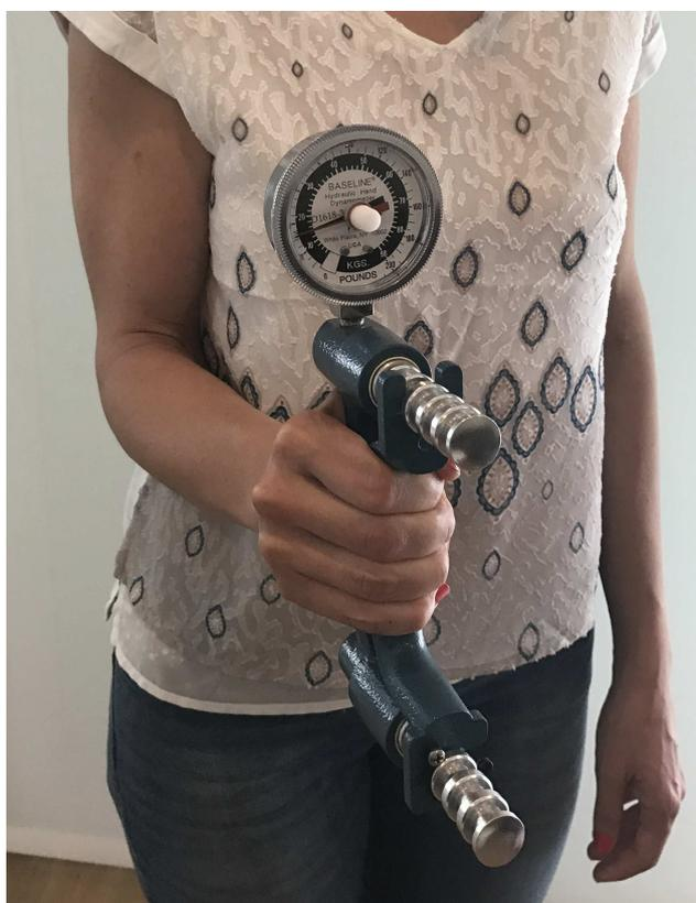
Fig. 26: posición de la mano con el codo pegado al cuerpo para realizar medición de fuerza de presión con dinamómetro de Jamar.
