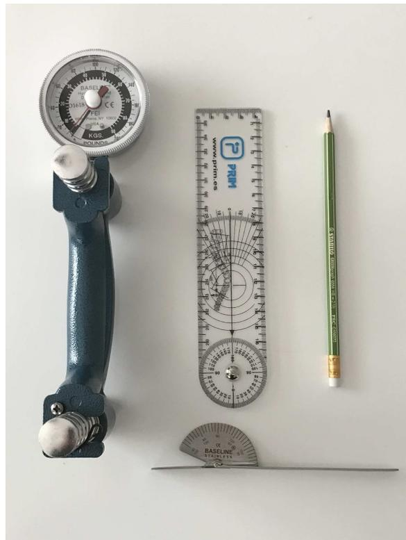
Fig. 23: Instrumentos de medida. Goniómetros Baseline ® y Prim ®, lápiz convencional y dinamómetro de Jamar.
