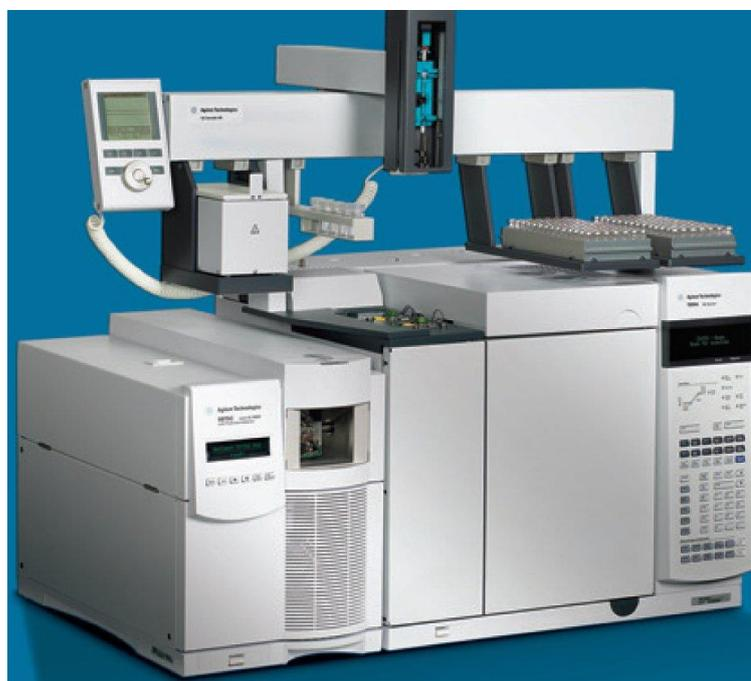
**Figura 3.1.** Cromatógrafo de gases Agilent GC7890 y detector de espectrometría de masas Agilent MS 5975.
