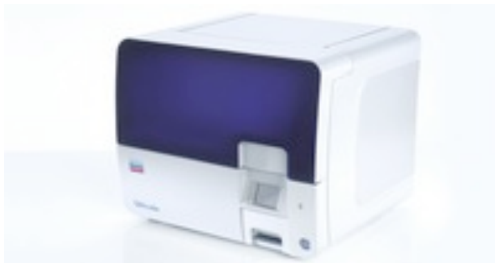
Figura 54. Imagen del sistema “QIAcube” (QIAGEN, Hilden, Alemania ) utilizado para la extracción automática del ADN.
