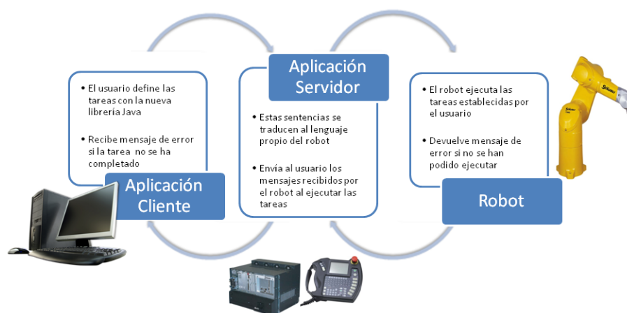
Figura 4.8: Esquema del protocolo de comunicación TCP/IP
