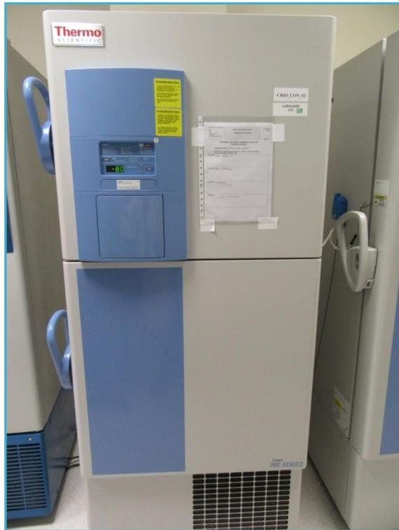
**Figura 3.10.:** ultracongelador vertical modelo Forma™ serie 900 de Thermo Scientific™.
