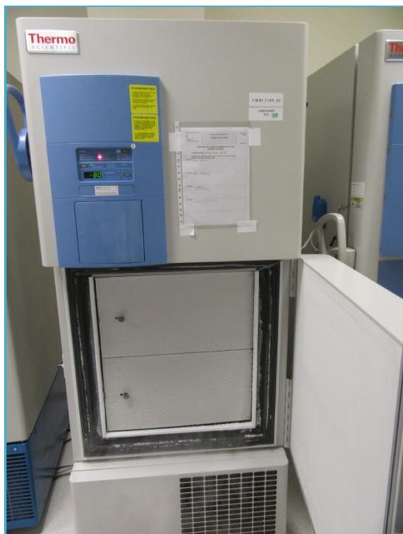
**Figura 3.11.:** ultracongelador vertical modelo Forma™ serie 900 de Thermo Scientific™.
