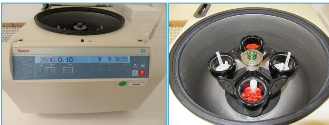
**Figura 3.6.:** Centrífuga modelo Thermo Scientific™ Sorvall™ ST 16.
