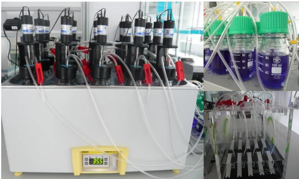
**Figura 4.1.-** Equipo AMPTS (Bioprocess Control) para la medida del potencial de biometanización en discontinuo.
