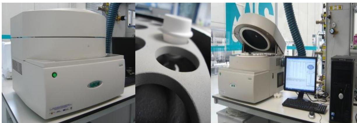
**Figura 4.2.-** Equipo Termogravimétrico para la medida de humedad, sólidos volátiles, carbono fijo y cenizas.
