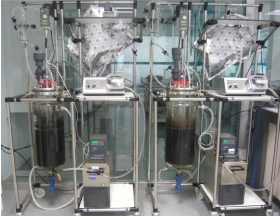
**Figura 4.3.-** Equipo de co-digestión anaerobia en semicontinuo.
