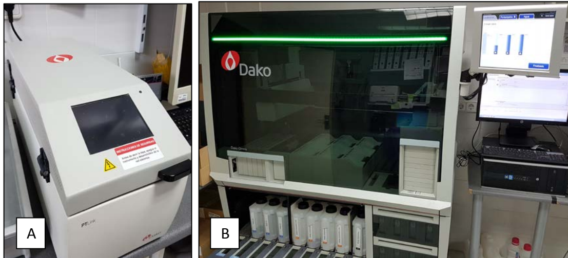
Imagen 14. Sistemas de procesamiento de muestras automatizado utilizados para las tinciones de Inmunohistoquímica en el HCUVA. A, Dako PT Link®. B, Dako EnVision FLEX+ Autostainer Link 48®.
