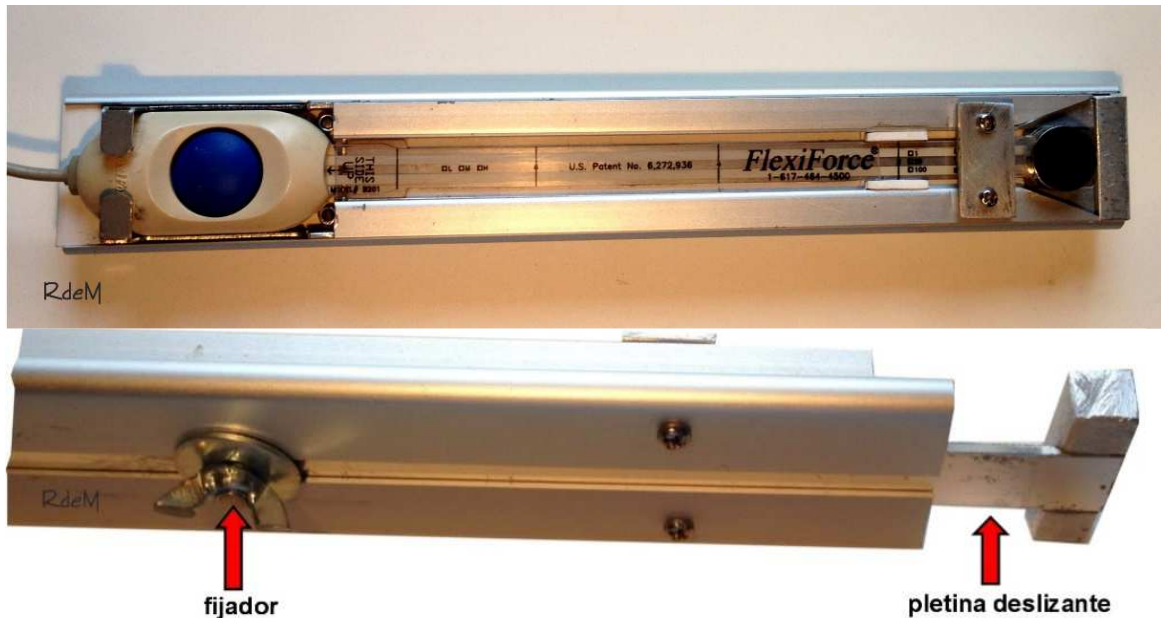
Figura 88: Base del Sistema de adaptación de la galga y prolongador para fijación articular.
