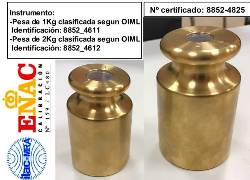
Figura 86: Pesas de calibración de 1 y 2 Kg y calibración.
