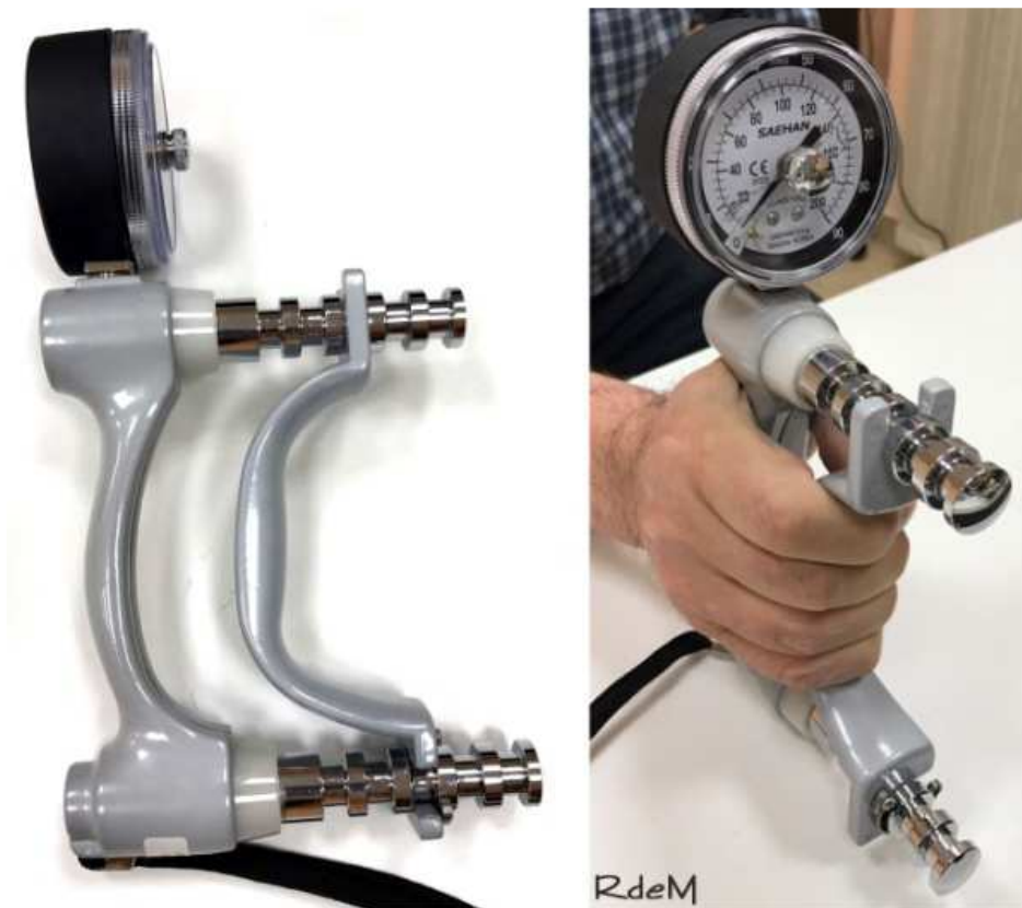
Figura 91: Sistema de medición Jamar puño.
