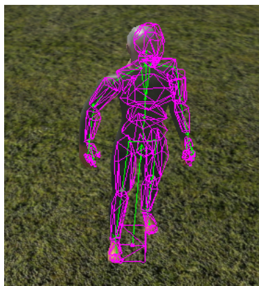
Figura 4.10: Controlador KinematicRagdollControl para simular las caídas según las leyes de la física. Este genera automáticamente objetos rígidos entorno a los huesos para simular el efecto de la física sobre los mismos (colisiones y gravedad).
