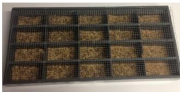
Fig. 34. Jaula para la irradiación con cubierta de celosía metálica.
