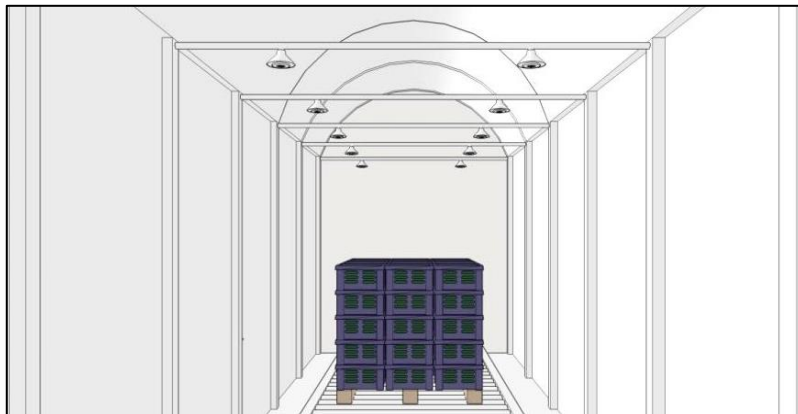
Hidro-enfriamiento tipo ducha
