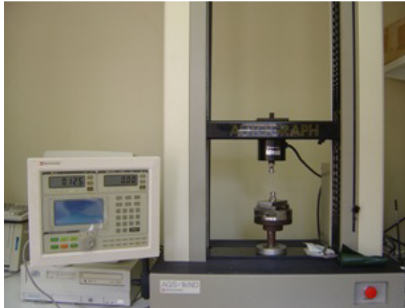
Figura 14. Máquina Universal de Ensayos (Autograph AGS-1KND, Shimadzu®, Kioto, Japón).
