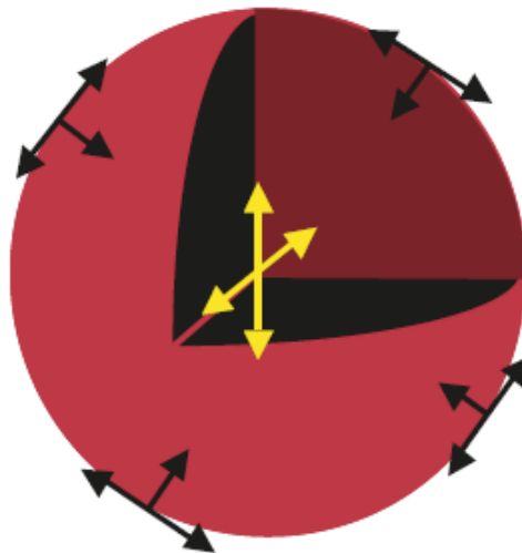
Figura 1. Gota esférica de sangre en sección transversal que muestra las fuerzas de tensión superficial. Fuente: James, Kish y Sutton 2005.
