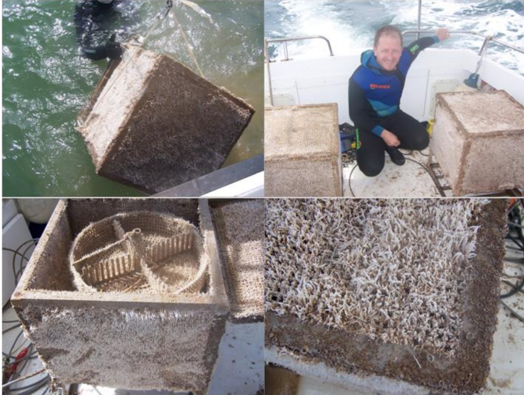
Figura 4.10. Imágenes de biofouling en estaciones S3 y S4 encontrado al final del muestreo de primavera.
