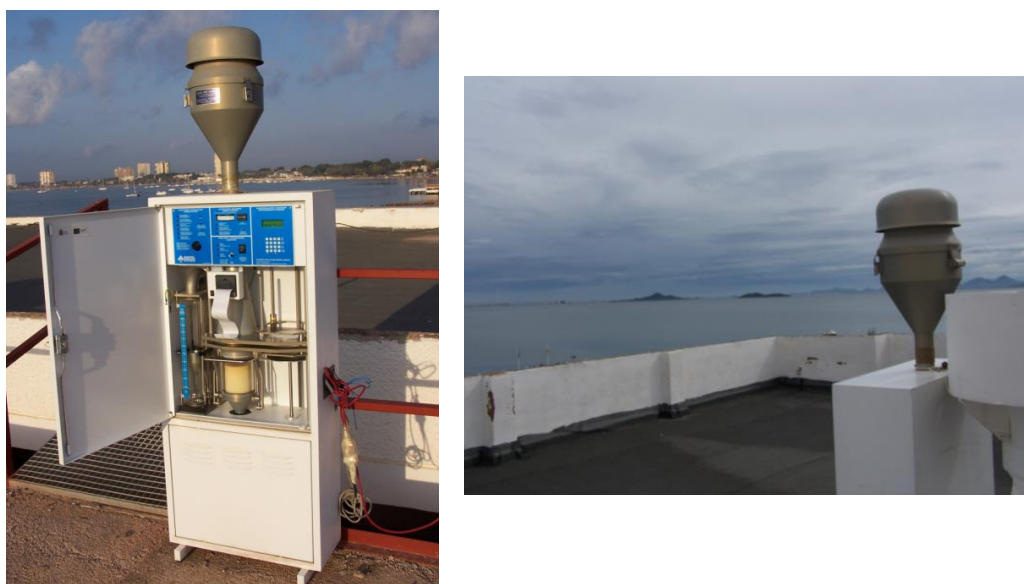
Figura 2.7. Fotos del muestreador activo DIGITEL-80 utilizado en este estudio. Foto Izquierda: instalado en el Centro Oceanográfico de Murcia (agosto 2009). Foto Derecha: instalado en edificio de Los Alcázares (enero 2010).
