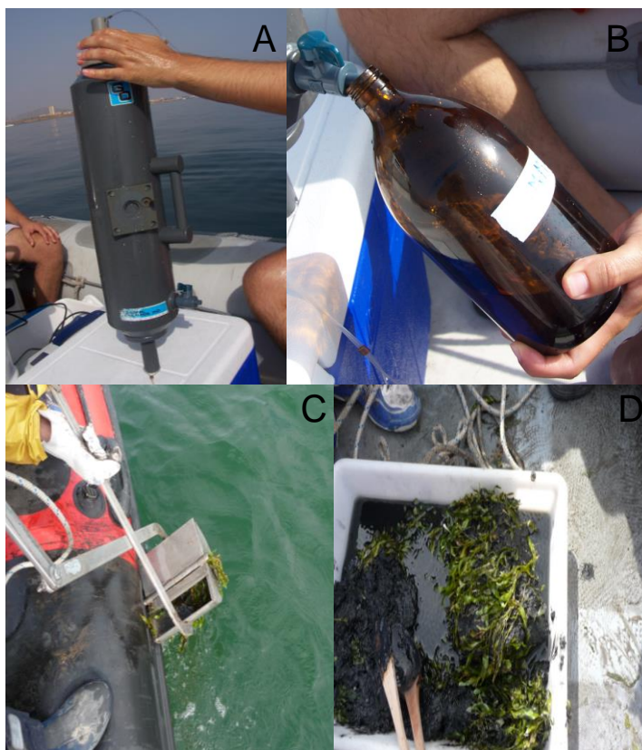
Figura 3.3. Botella Niskin utilizada para muestreo de agua (A), botella de vidrio ámbar para conservar muestras de agua (B), draga van Veen (C) y detalle sedimento superficial (D).
