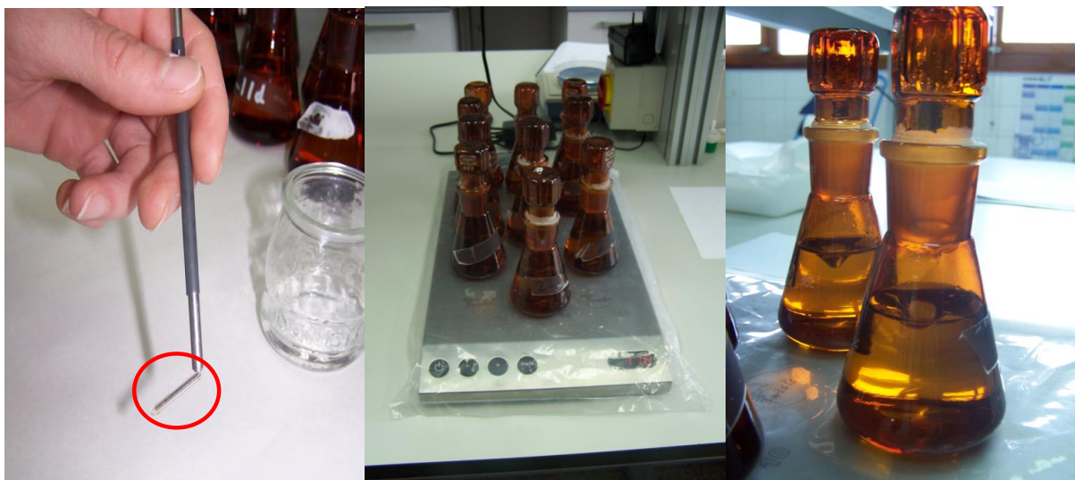
Foto 3.1. Detalle de barra agitadora magnética o Twister®, y agitación durante la extracción.
