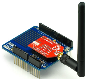
Figura 27. Imagen de la placa Arduino WiFi Shield incluyendo la antena de comunicaciones para la banda de frecuencia de 2 GHz (fuente www.aliexpress.com )
