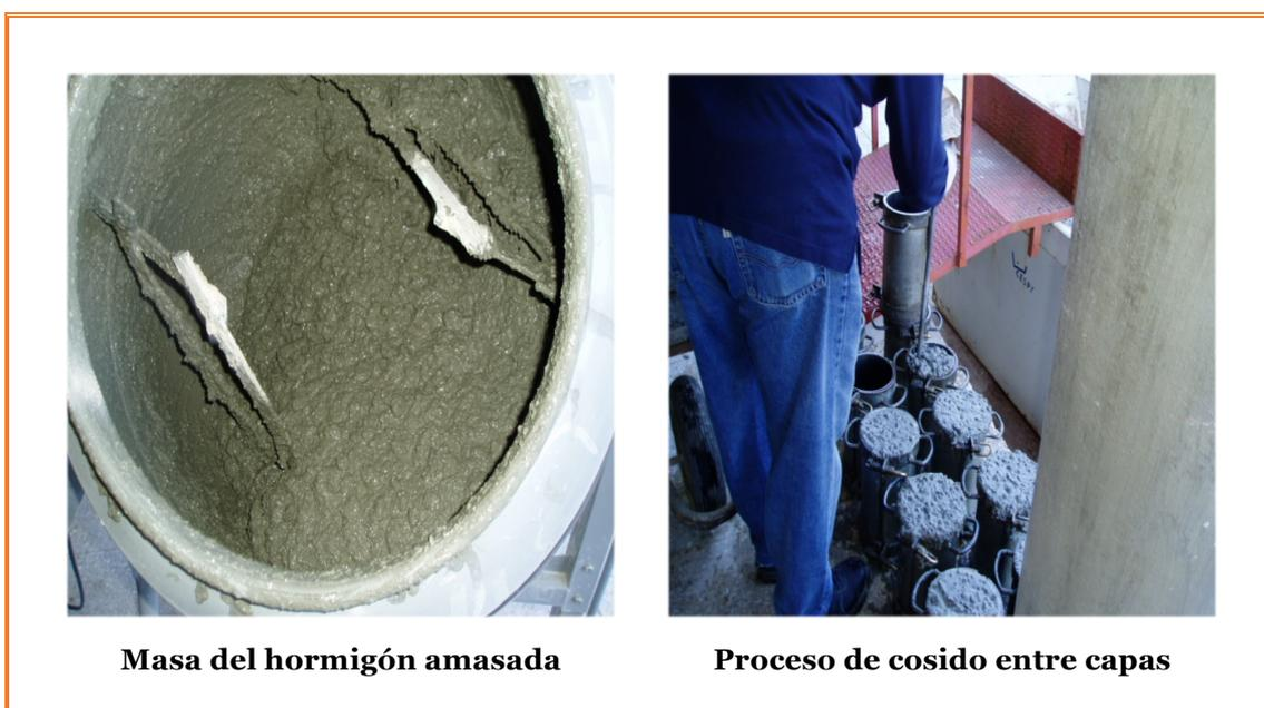
**Figura 4.4.2.** Fabricación del hormigón.
