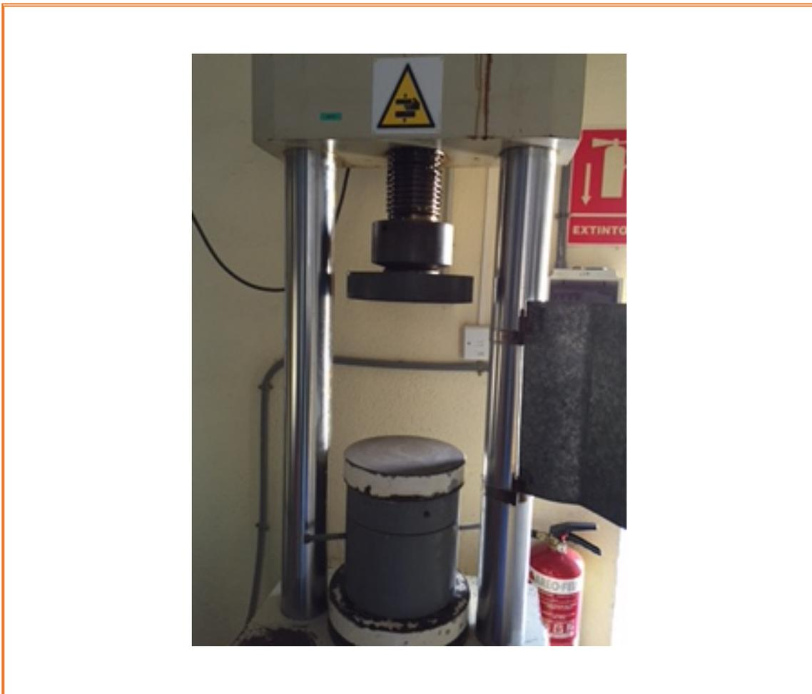
**Figura 4.5.2.2.** Prensa dinámica marca SERVOSIS modelo 150T.
