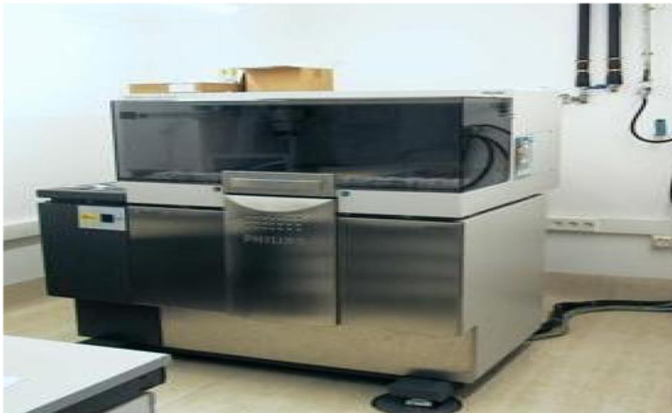
**Figura 4.5.1.9.** Espectrómetro de Fluorescencia modelo MAGIXPro de Philips.
