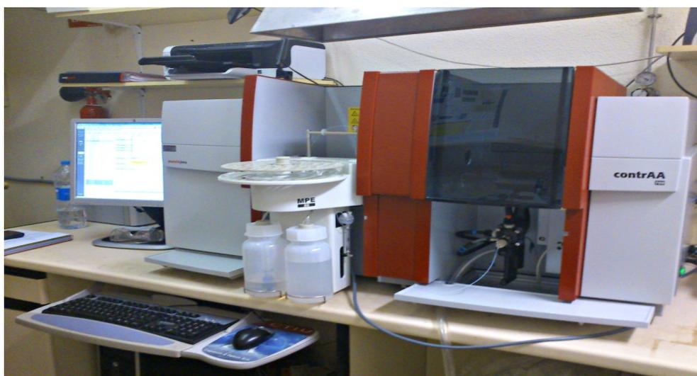
**Figura 4.5.1.5.** Espectrómetro de absorción atómica en llama y grafito, CONTRA AA700.
