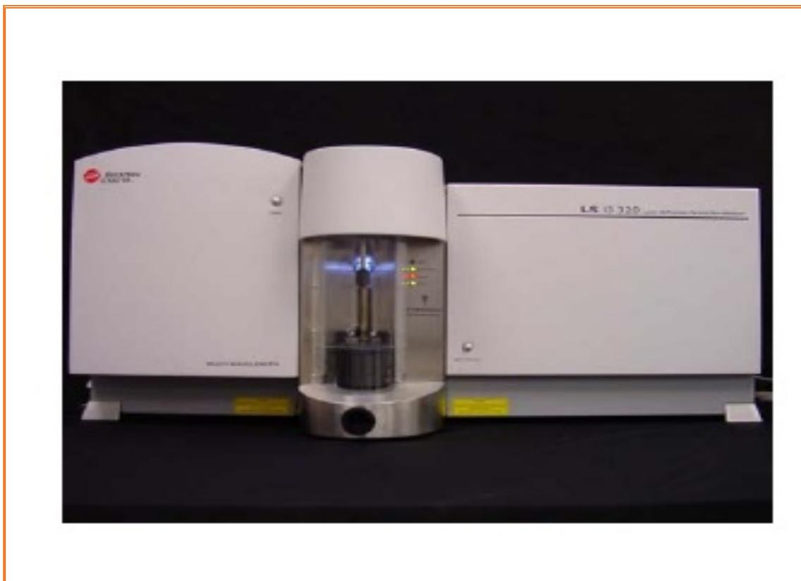
**Figura 4.5.1.3.** Analizador de tamaño de partículas LS 13 320 Beckman Coulter (en seco).
