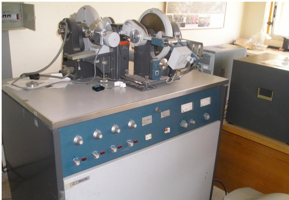
**Figura 4.5-1.10.** Difractómetro de RX Philips PW3040.
