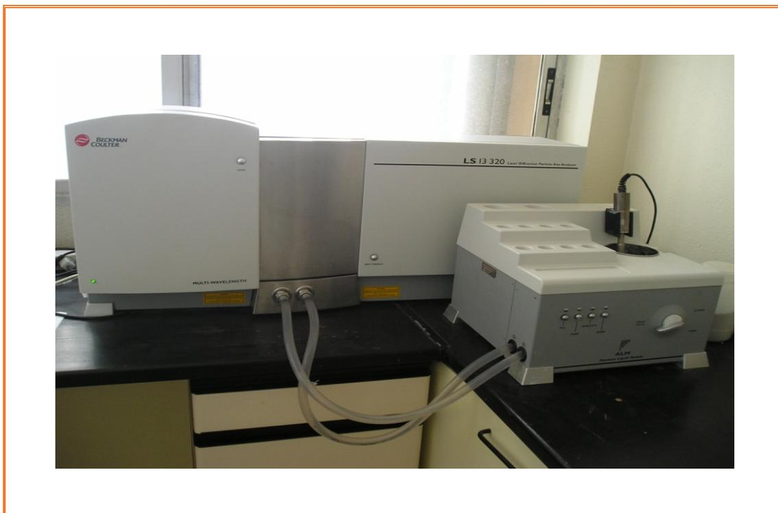
**Figura 4.5.1.2.** Analizador de tamaño de partículas LS 13 320 Beckman Coulter (en líquido).
