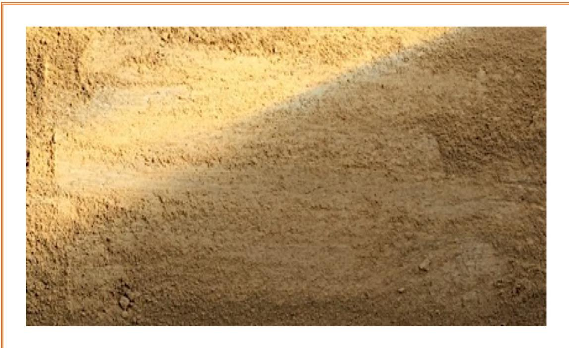
**Figura 5.3.2.4.** Superficie de la probeta inmersa 64 meses al 100% en agua de mar y sedimento  $O_2$ .
